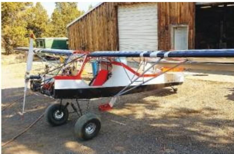
La preoccupazione maggiore per Jackson fu che il velivolo era stato progettato attorno a un pesante motore a prua e un piccolo serbatoio in coda. Per superare l’ostacolo, Jackson installò le batterie in due differenti posizioni per suddividere il peso: una dietro al sedile e l’altra davanti. “Stavo deviando alquanto dall’originale avendo due batterie pesanti e un motore leggero” diceva Jackson. Le batterie pesano circa 79 lb ciascuna, mentre il
