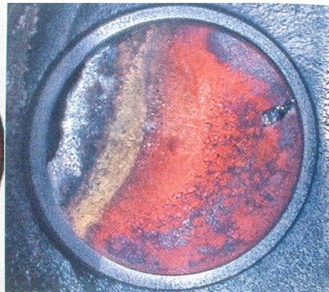
Spedii via il cilindro per la riparazione. Ritornò indietro con una valvola di scarico nuova e qualche ripresa nella sede della valvola. Reinstallai il cilindro sul motore, dove sta funzionando benissimo dopo 20 anni e circa 3000 FH.
