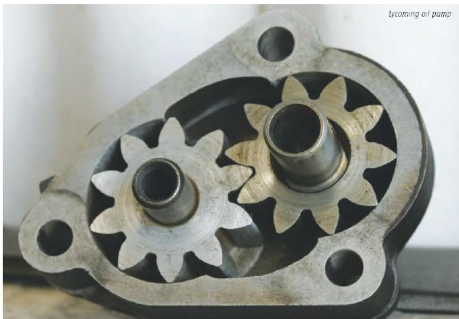
Tutte le pompe dell'olio consistono in due ingranaggi accoppiati che ruotano all'interno della carcassa, uno mosso dal motore, l'altro trainato dal primo. Quando gli ingranaggi ruotano, l'olio prelevato dalla coppa è spinto all'esterno dagli ingranaggi. Prima di entrare nel motore, una di queste valvole entra in funzione.
