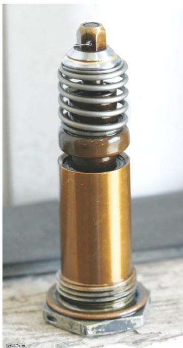
La variazione della velocità di rotazione della pompa dell'olio dal minimo al massimo dei giri motore e la fluttuazione della viscosità dell'olio a causa delle variazioni della sua temperatura sono compensate dalla tensione della molla della valvola di sovrappressione.
